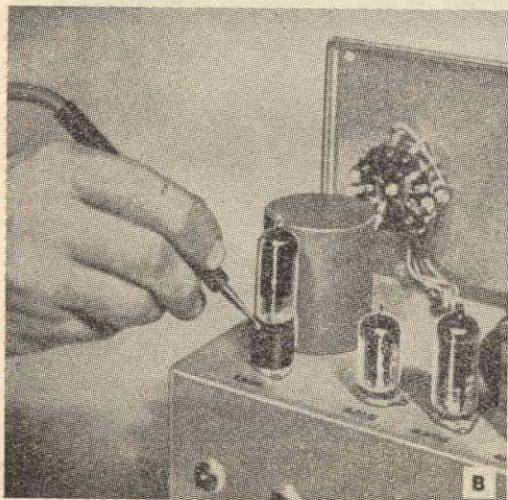
Foto B - Un adattatore per prova valvole miniatura permette di eseguire il controllo delle basi delle valvole sul telaio. Basta inserire l'adattatore nello zoccolo della valvola e inserire la valvola nell'adattatore. Con questo sistema non vengono disturbati i collegamenti eseguiti sul rovescio dello zoccolo.
