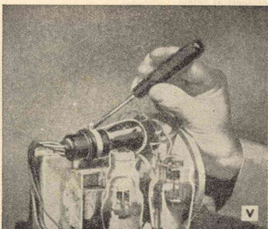
Foto V L'occhio magico, la valvola indicatrice di sintonia montata in molti tipi al di sopra delle altre parti del telaio e dirimpetto ad una piccola apertura nel mobile, può provocare rumori che danno un poco disturbo. Se il morsetto si allenta, tutto l'insieme della valvola si muove e può colpire la superficie della scala od altre parti dell'apparecchio, quando il controllo di volume è completamente aperto o si sta ascoltando la trasmissione locale, il cui segnale è naturalmente molto forte. Quando ciò si verifica, occorre serrare con un cacciavite la vite del morsetto, e, se l'inconveniente non può essere così eliminato, forzare qualche spessore tra morsetto e valvola.
